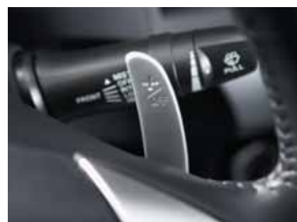
Кнопки переключения передач, встроенные в рулевое колесо (только для моделей с бесступенчатым вариатором CVT)
